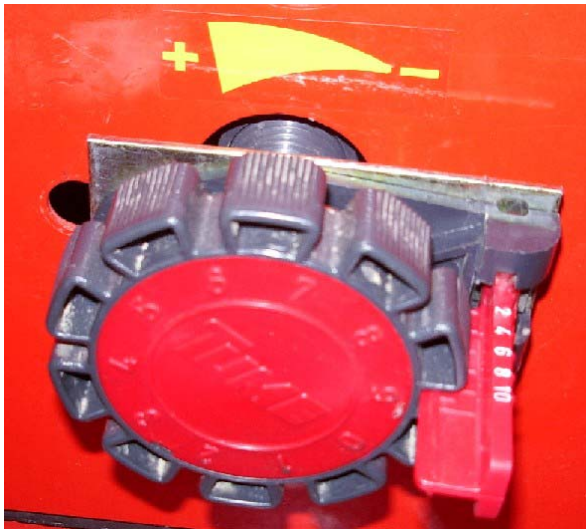
KUVA 9. Syötön säätö käsipyörästä
