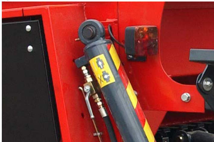
KUVA 20. Nostosylinterin turvaventtiili avattuna
