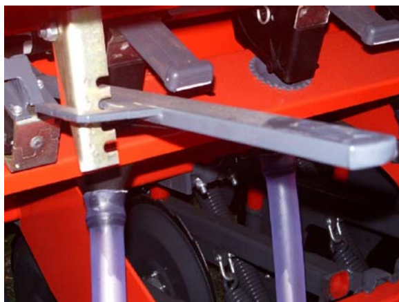
KUVA 12. Siemenen pohjaläppien säätö
