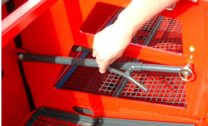
Kuva 8. Säiliön väliseinän säätötanko.
