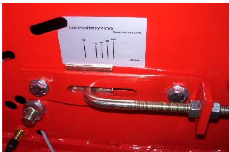
Kuva 19 Lannoitteen sijoitussyvyyden säätö
