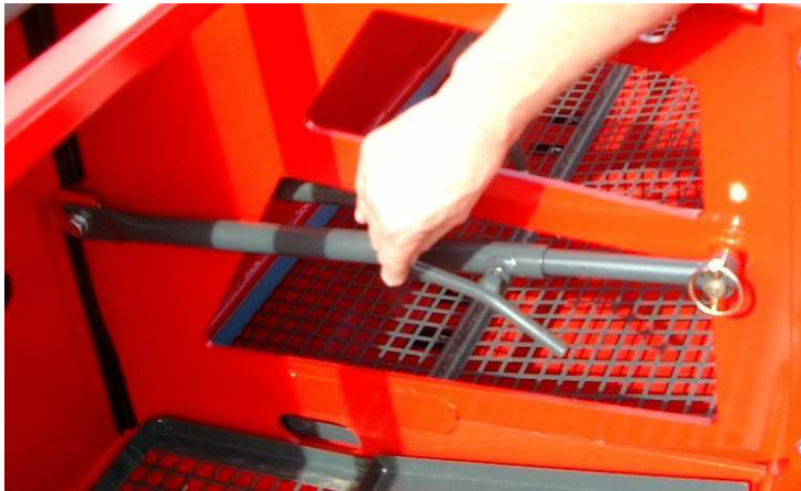
Kuva 8. Säiliön väliseinän säätötanko.
