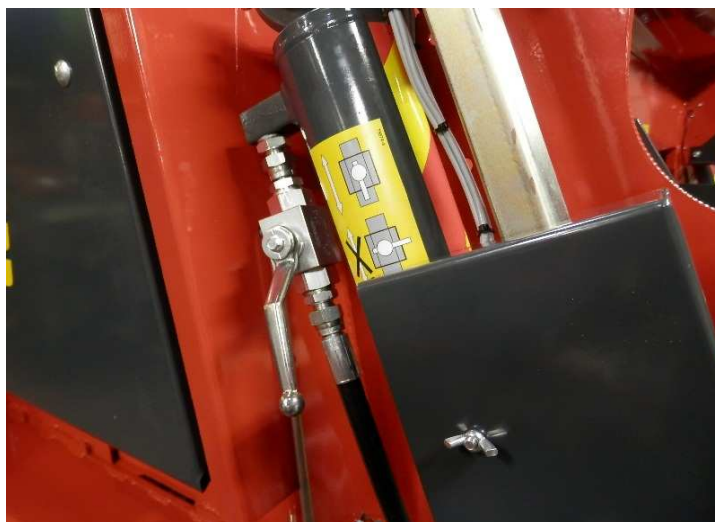
Kuva 20. Nostosylinterin turvaventtiili avattuna
