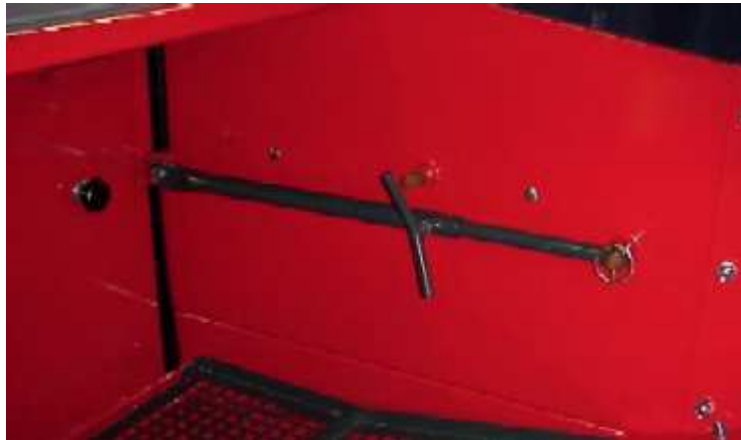
Kuva 8. Säiliön väliseinän säätötanko.
