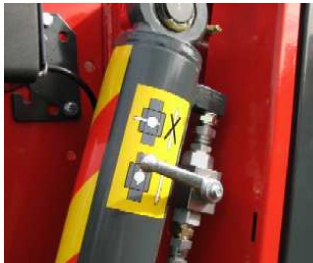
KUVA 20. Nostosylinterin turvaventtiili suljettuna
