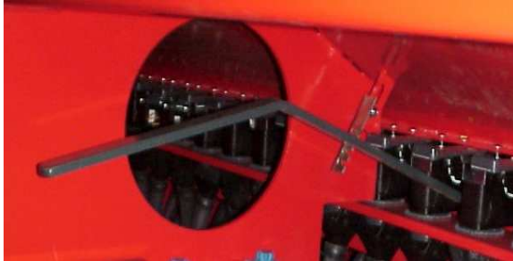
KUVA 12. Siemenen pohjaläppien säätö
