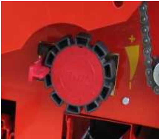
KUVA 9. Syötön säätö käsipyörästä
