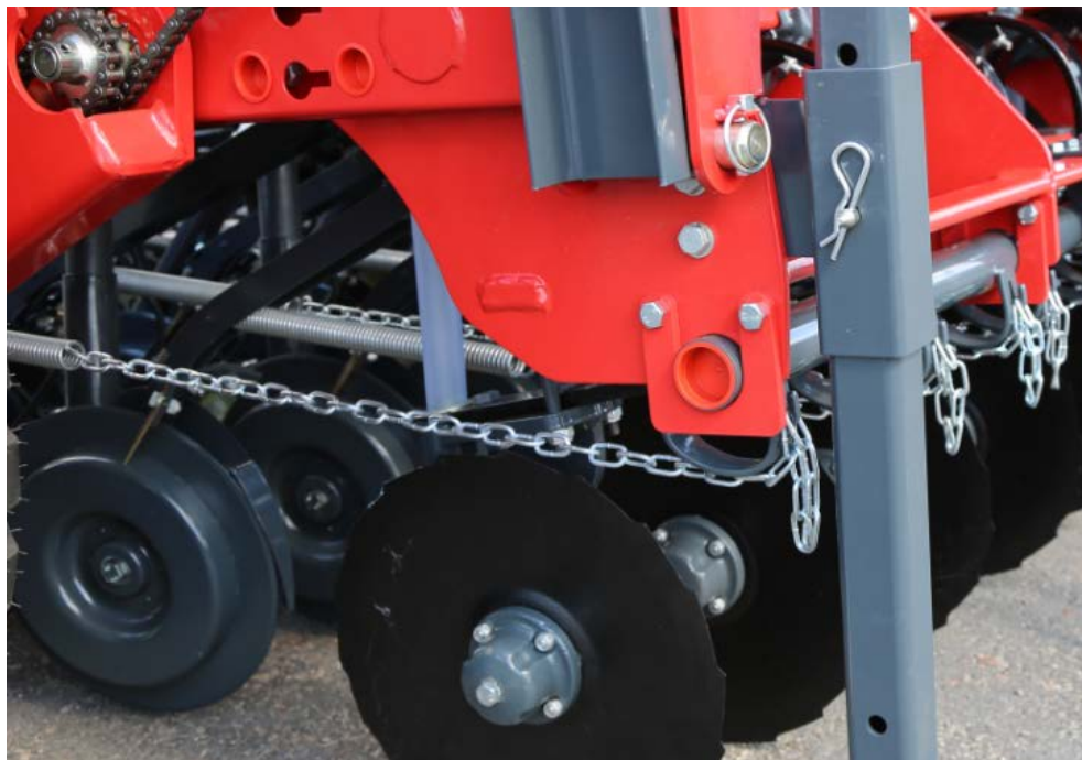
Kuva 16. Keskussäätöputki, ja vannaskettingit
