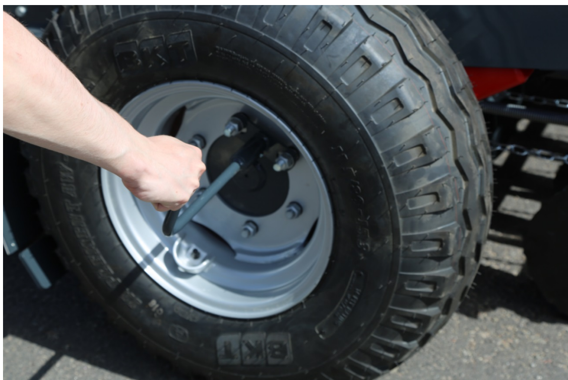
Kuva 13. Kiertokoeveivi asennettuna paikalleen
