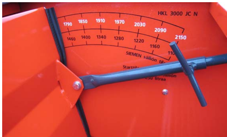
Kuva 13. Väliseinän säätötanko ja säiliöiden tilavuusasteikko
