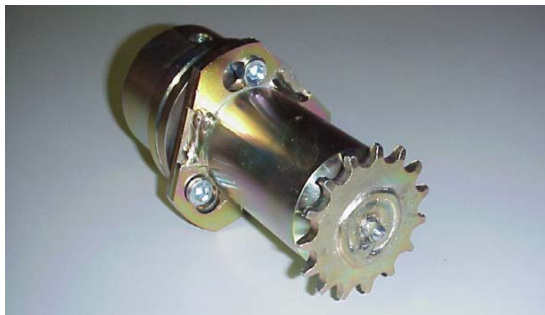
Kuva 10. Voimansiirron vapautuskytkin kylvöasennossa
