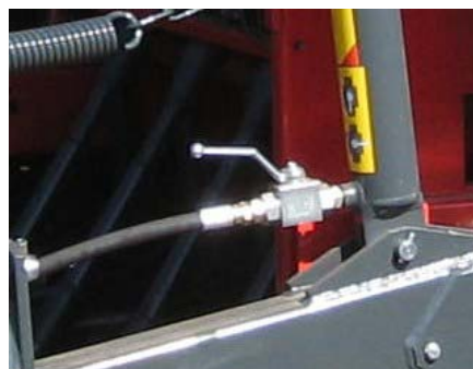
KUVA 34. Nostosylinterin turvaventtiili auki
