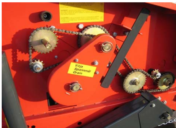
Kuva 16A . Voimansiirronkasetti I = Vilja
