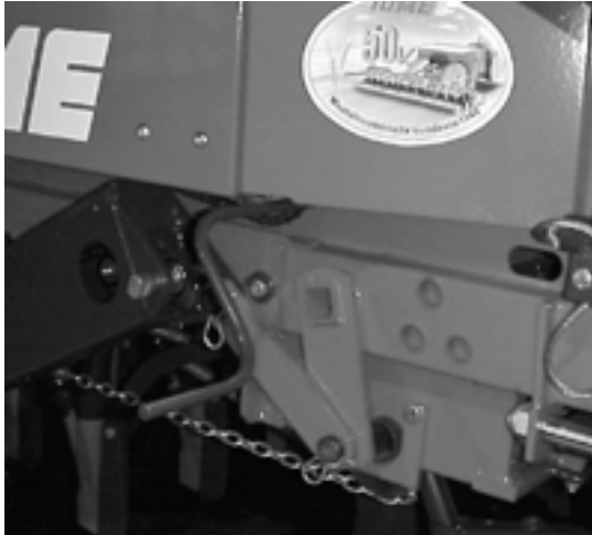
KUVA 18. Kiertokoe lannoitepuolelle (vier. kuva: kiertokoepussien sijoitus) Kiertokokeen suoritus:
