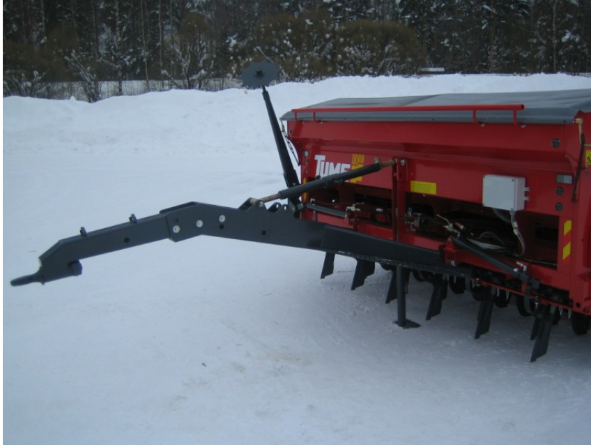
Kuva 8 e. Monitoimivetoaisa asennettuna yläpuoliseksi aisaksi.
