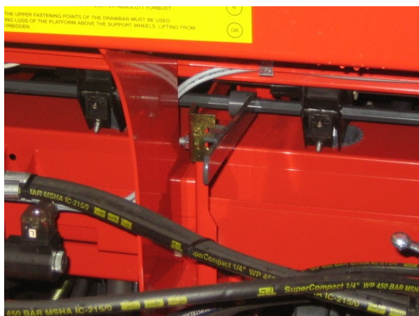
Kuva 22. Pohjaläppien säätövipu, lannoite
