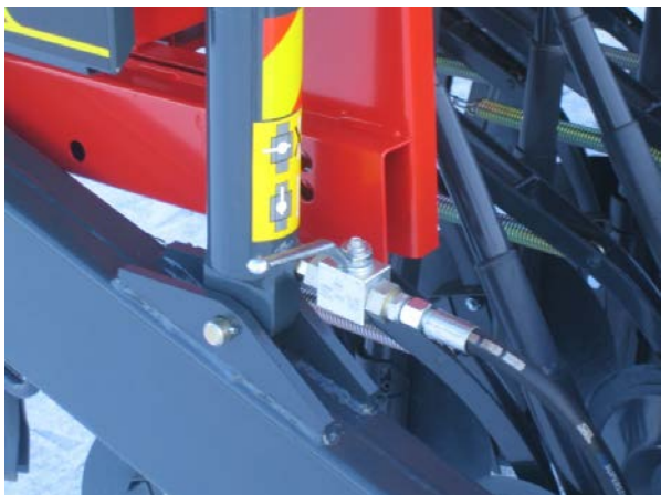
Kuva 34. Nostosylinterin turvaventtiili suljettuna
