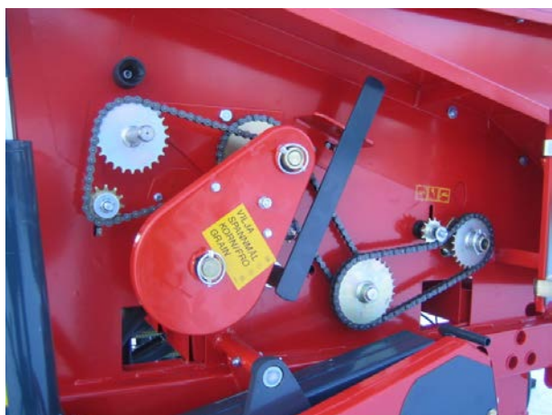
Kuva 18. Voimansiirtokasetti I = VILJA
