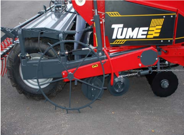
Kuva 10. Maapyörä työasennossa (kone alhaalla)
