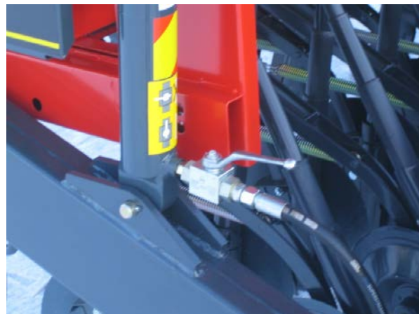
Kuva 35. Nostosylinterin turvaventtiili auki
