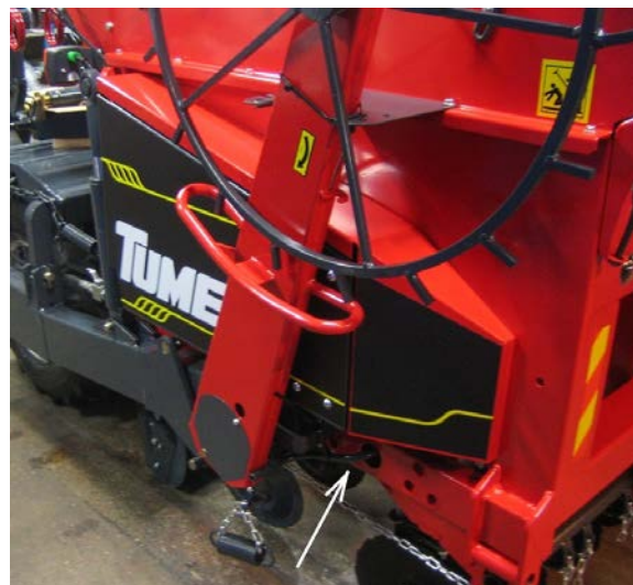
Kuva 5. Maapyörä autokuljetus-asennossa. (Nuoli, painatuksen säätöveivi)
