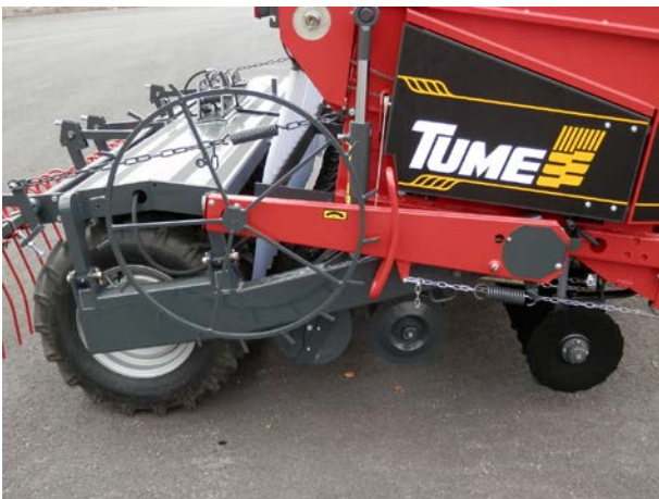
Kuva 11. Maapyörä kuljetusasennossa (kone ylhäällä)
