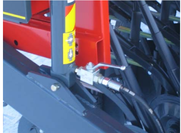
Kuva 39. Nostosylinterin turvaventtiili auki
