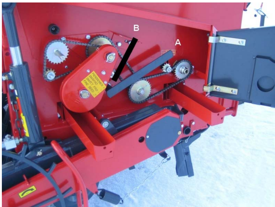
Kuva 30. Siemenpuolen kiertokoejärjestelmän käyttö
