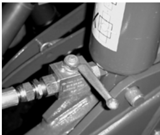
KUVA 38. Nostosylinterin turvaventtiili suljettuna
