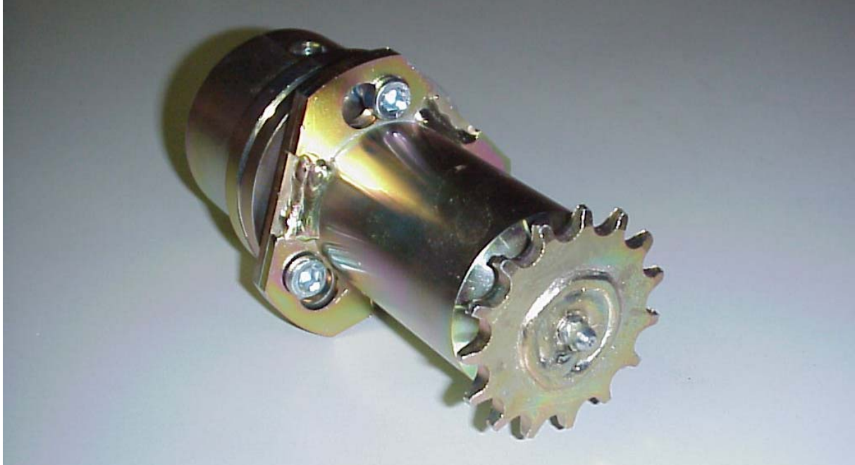
KUVA 14. Voimansiirron vapautuskytkin kylvöasennossa. Voima kannatuspyöriltä välittyy voimansiirtoon.
