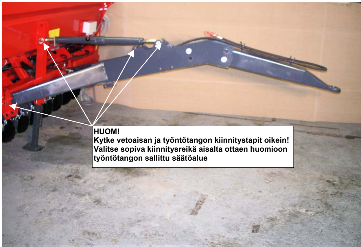
KUVA 7. Monitoimivetoaisa mekaanisella työntötangolla asennettuna yläpuoliseksi aisaksi
