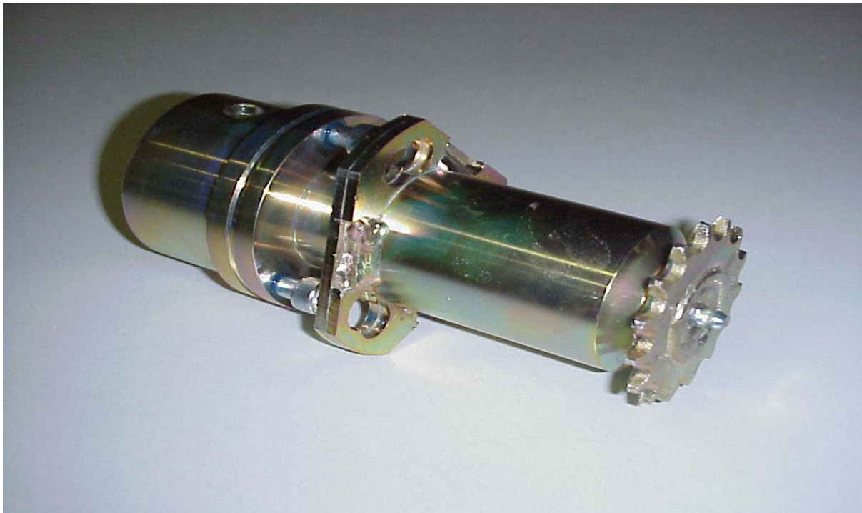
KUVA 13. Voimansiirron vapautuskytkin vapaa-asennossa siirtoajoa varten
