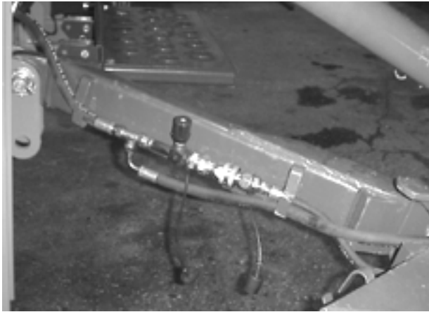
KUVA 4. Hydraulisen työntötangon säätöventtiili
