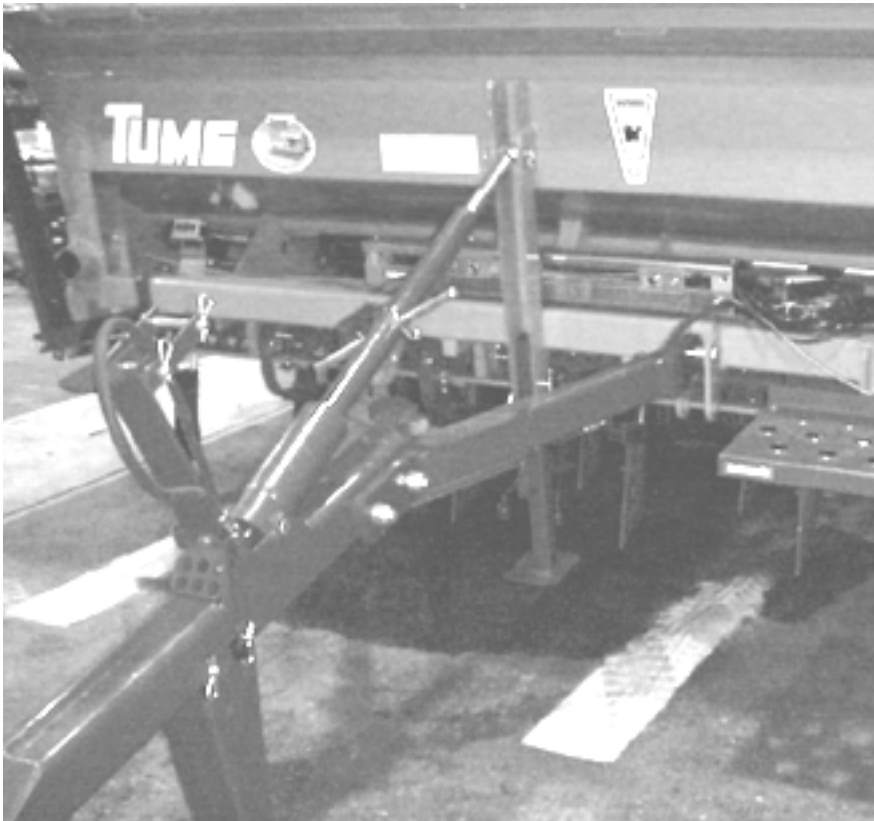
KUVA 3. Vetolaitteen kiinnitys koneeseen
