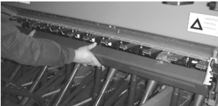
KUVA 17. Koekylvökaukalo käännetään ylös paikoilleen
