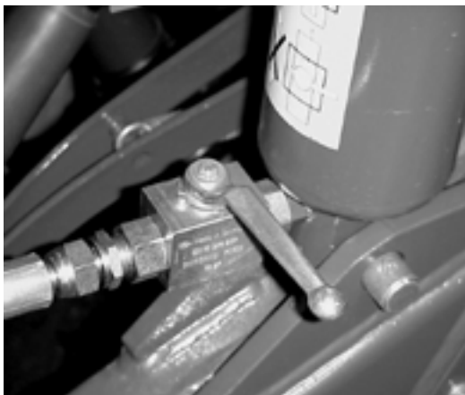
KUVA 25. Nostosylinterin turvaventtiili suljettuna
