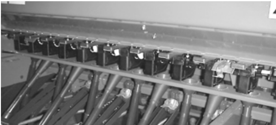
KUVA 15. Suppilohylly työnnetään eteen
