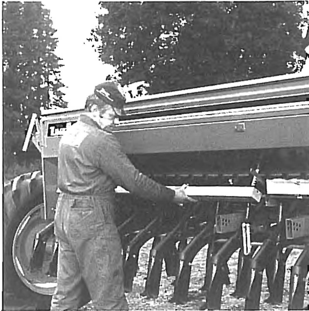
KUVA 22. Koekylvökaukalot käännetään alas
