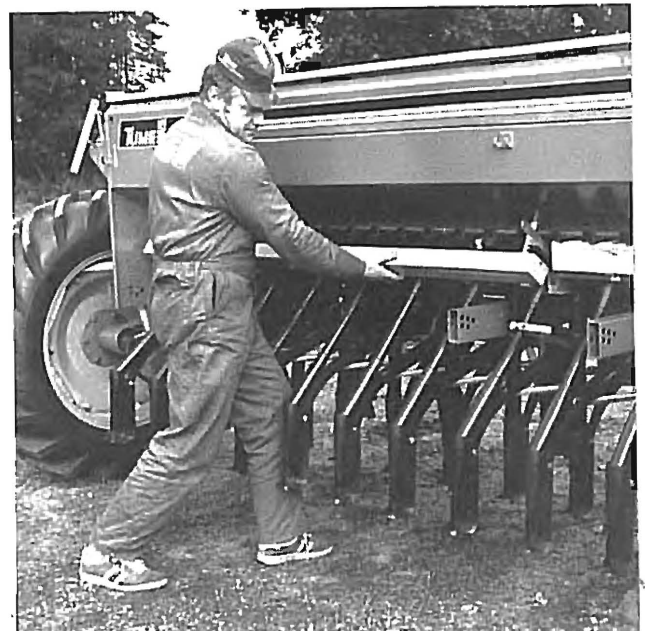
KUVA 25. Koekylvökaukalo käännetään ylös paikalleen
