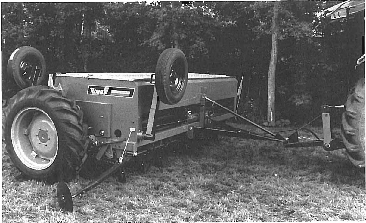
KUVA 8. Pitkittäiskuljetuksella varustettu kone työasennossa
