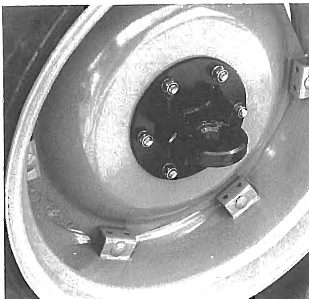
KUVA 11. Vetolenkki pyörän navassa
