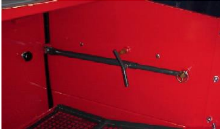
Kuva 42. Säiliön väliseinän säätötanko.
