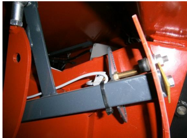
Kuva 33. Jälkiäkeen nostokohdan säätö.
