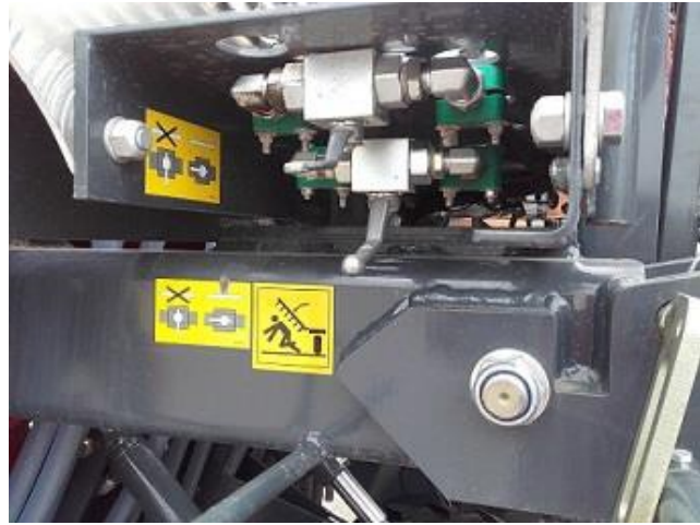
Kuva 35. Jälkiäkeen venttiili (alempi) kiinni kuljetuksessa ja säilytyksessä.
