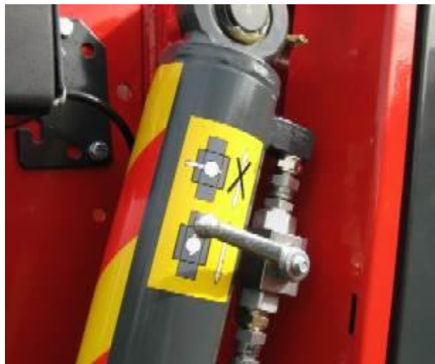
KUVA 54. Nostosylinterin turvaventtiili suljettuna
