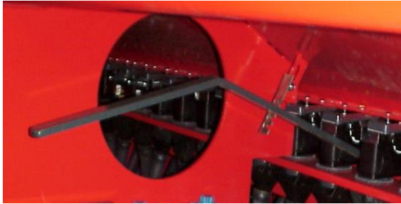
Kuva 46. Siemenen pohjaläppien säätö
