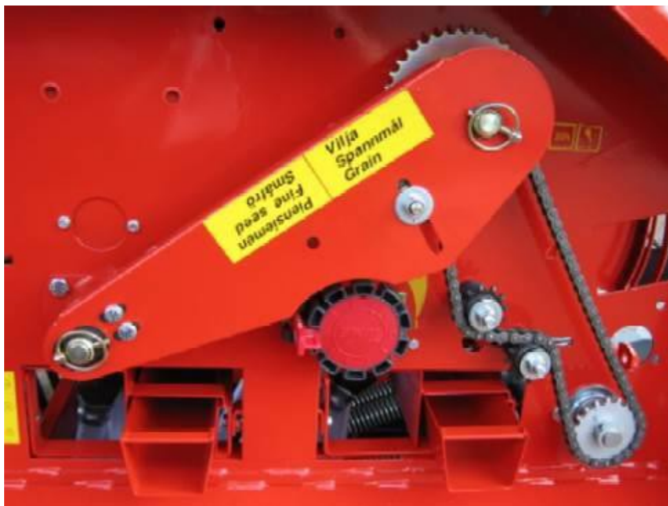
Kuva 45. Voimansiirtokasetti. I = Vilja, II = Pienisien
