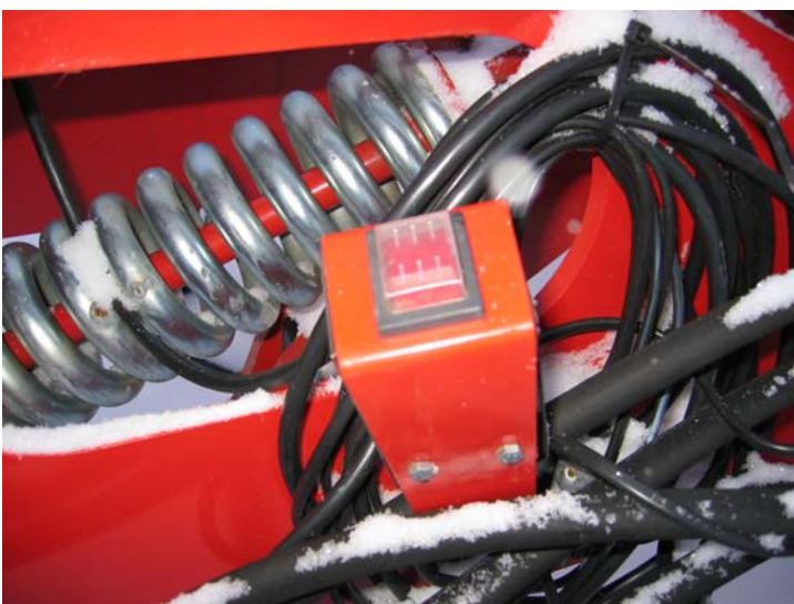
Kuva 9. Sähkökatkaisin muokkaimen työsyvyys säätöön työskentelyn aikana.
