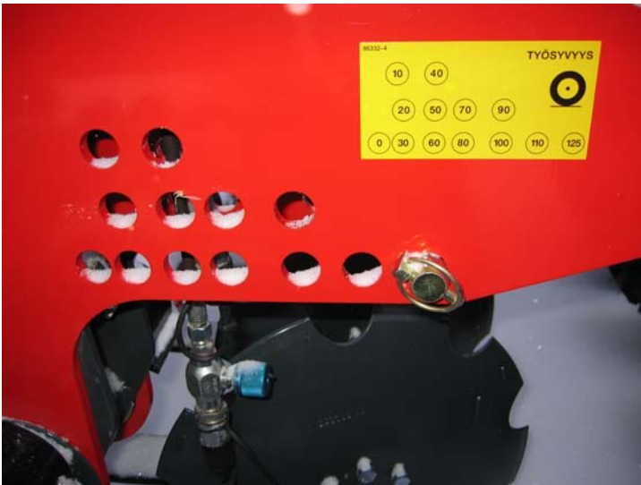
Kuva 8. Lautasmuokkaimen työsyvyys säätö
