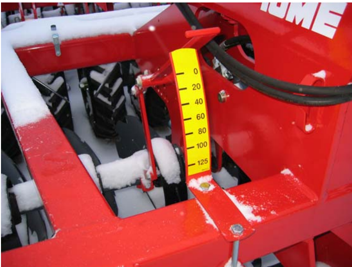
Kuva 8b . Lautasmuokkaimen työsyvyys mittari.
