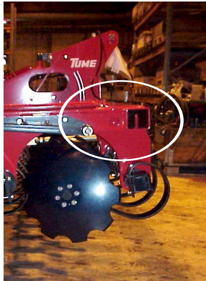
Kuva 5. Muokkaimen etupalkin sisään voidaan sijoittaa lisäpainoja
