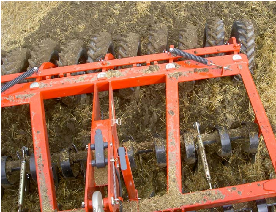
Kuva 11. Muokkaimen kääntyvät kannatinpyörät sallivat päisteajon konetta nostamatta
