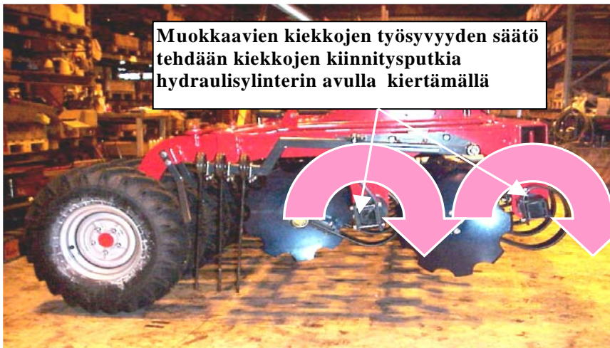
Kuva 2. Työsyvyys säädetään kiekkojen kiinnitysputkia kiertämällä. Kuvassa kuljetusasento.
