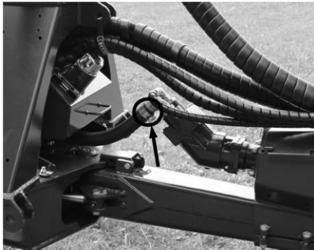
Hydraulipumpun letkun irrottaminen
