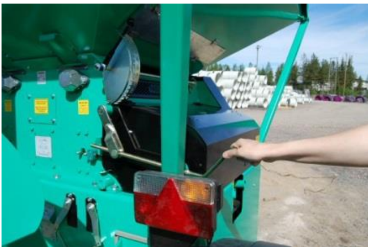
Kuva. Valssin pikasäätö säätökammella.
