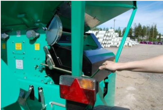
Kuva. Valssin pikasäätö säätökammella.
