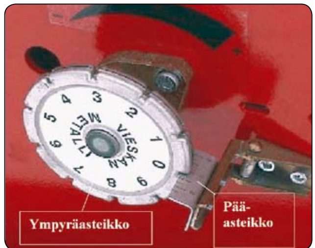
Kuva 3.7 Säätöpyörä ja asteikot
