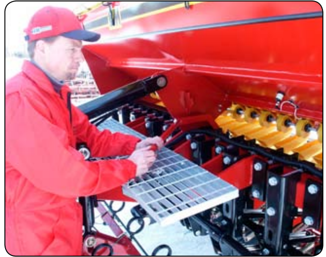
Kuva 3.4 Syöttösuppilosto lasketaan alas.
