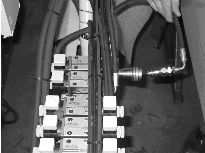
Vapaakiertoventtiin pikaliittimien yhdistäminen toisiinsa.
