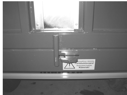
Hydraulinen takalaitalukko TRM vaunussa auki-asennossa
