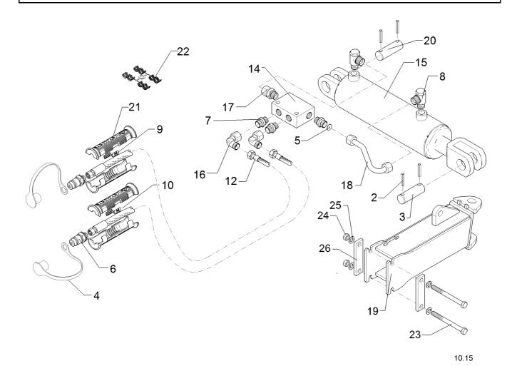
Artikeltext Pos. Art.Nr. Stck. Description Abmessung 303 0978 Hexagon nut M20 DIN934-8 Zn 24 2 Sechskantmutter 25 305 6012 4 Scheibe Washer 21 ISO7089 Zn 26 459 1155 2 Brücke Clamp plate 50x15x200 2xD21-162
