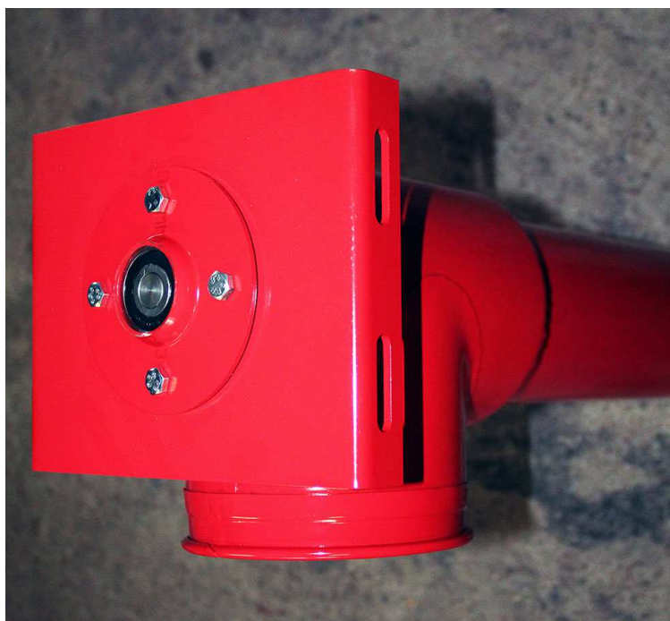
Yläpään laakeri asennettuna paikalleen
