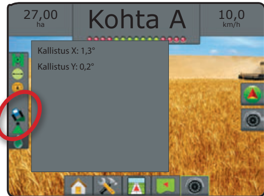
Kuva 8-8: Kallistuksen korjauksen tila
