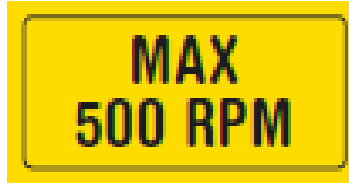
Nivelakselin maksimi kierroslukumäärä 500r/min
