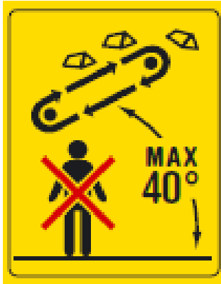
Kuljettimen maksimi käyttökulma 40° Älä kulje kuljettimen alta
