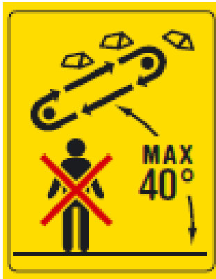
Kuljettimen maksimi käyttökulma 40° Älä kulje kuljettimen alta
