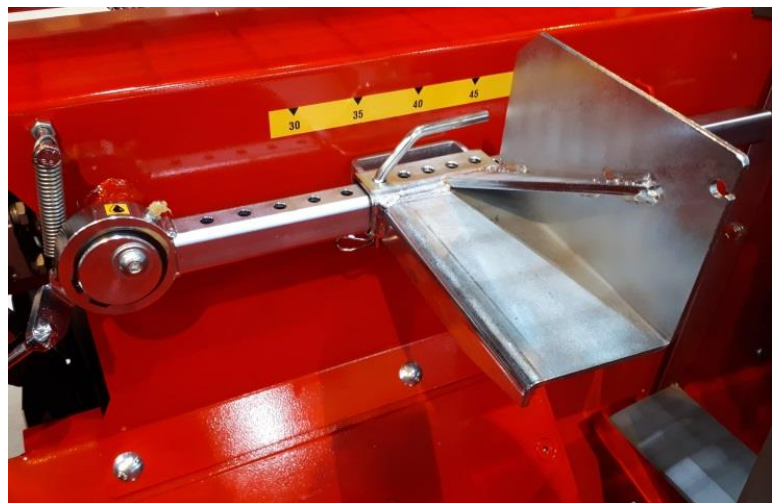
Kuva 15: Mittalaitteen asento suurille, halkaisijaltaan yli 25cm puille
