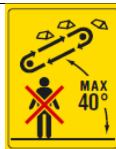
Kuljettimen maksimi käyttökulma 40° Älä kulje kuljettimen alta
