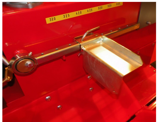
Kuva 18. Mittalevyn asento pienille puille.
