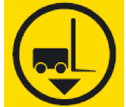
Koneen nostokohta trukille
