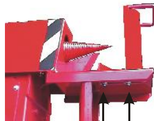
Telineen etäisyyttä kartiosta voidaan säätää telineen alla olevista muttereista
