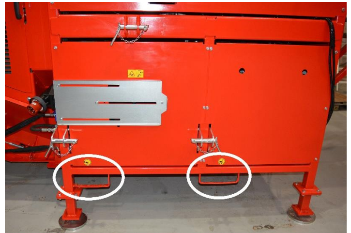
Kuva 1. Koneen nostokohdat trukkipiikeille (2 kpl).
