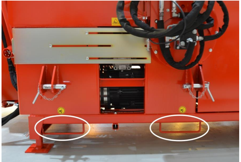
Kuva 1. Koneen nostokohdat trukkipiikeille (2 kpl).
