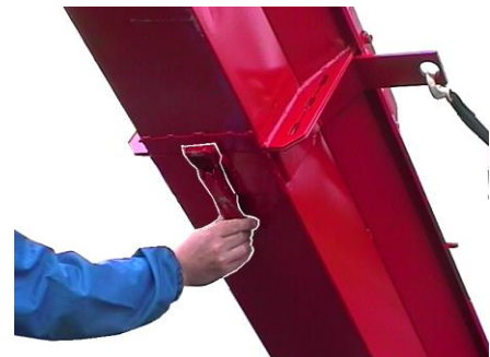
6. Säädä kuljetin vinssillä haluamaasi kalte- vuuteen ja lukitse jatke kuljettimen pohjassa olevalla lukolla
