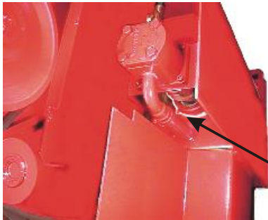
Hydraulipumpun käyttö-akselin laakerit
