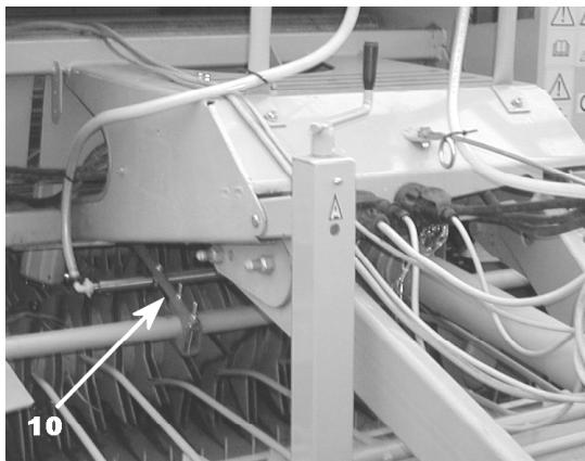
Montera munstycksröret på ett lämpligt ställe på maskinen med tillhörande fästen **nr.10**
