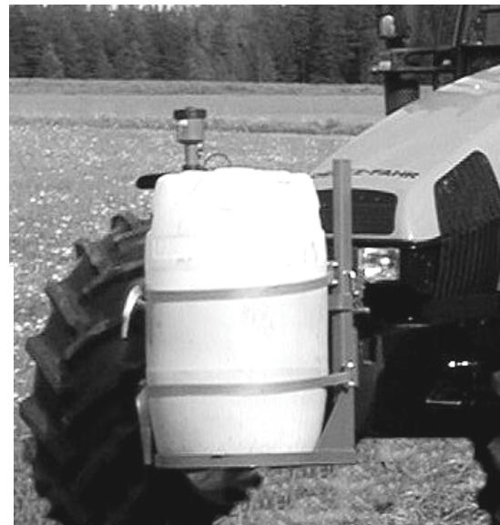
Elkabeln **nr. 5** dras till traktorns körljus kontakt. Anslut pumpens kabel **nr.6** till elkabeln, svart - svart och grå – grå. Svart = +12V, grå –
