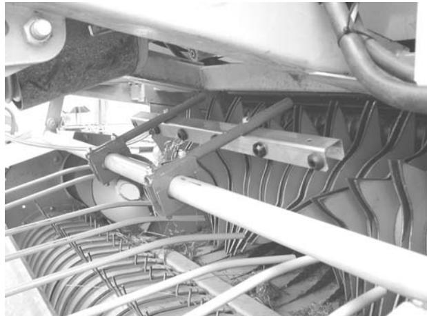
För hack så finns det att tillgå punktspridar munstycke som är tillverkad i rostfritt syrafast stål som monteras i hackens utblås.
