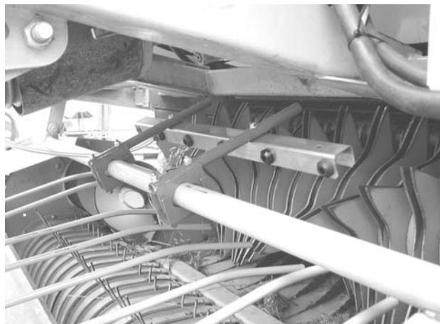
Silppurile löytyy haponkestävästä teräksestä valmistettu suutin joka laitetaan silppurin torveen.
