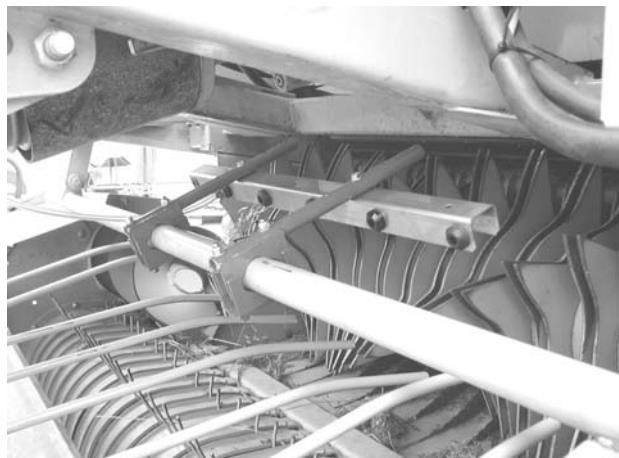
Silppurile löytyy haponkestävästä teräksestä valmistettu suutin joka laitetaan silppurin torveen. **HUOM.! Virtaus n.1,5-2 l/min. Suuttimen reikä on porattava isommaksi jos isompi virtaus vaaditaan.**
