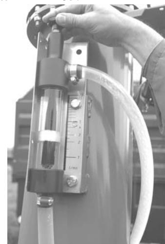
Säätää haluttuun virtaukseen säätöruuvilla **nro.6**
