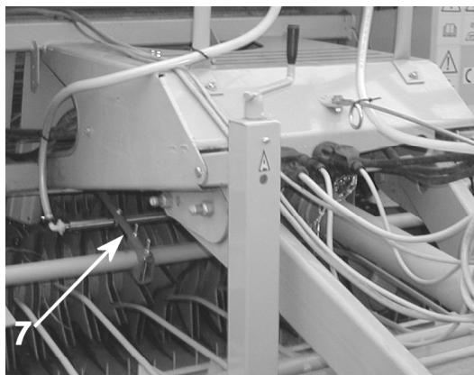
Kiinnitä suutinputken sopivan kohtaan karhon yläpuolelle (mieluummin tuulisuojassa) kiinikkeillä **no.7**.
