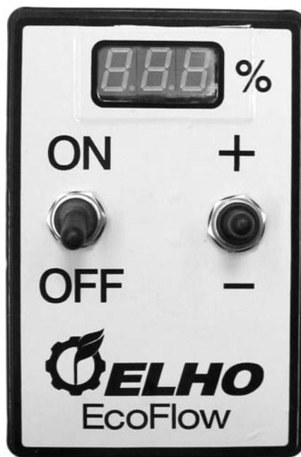
Då man vänder den högra brytaren mot + ökas motorns varvtal och då man vänder brytaren mot - minskas motorns varvtal. Procent talet sparas i minnet då brytaren lämnas orörd i två sekunder.
