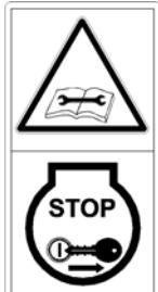
Tämä merkki kehottaa pysäytämään moottorin, kääntämään virran pois päältä, poistamaan virta-avaimen ja lukemaan käyttöohjeet ennen suojan poistamista.
