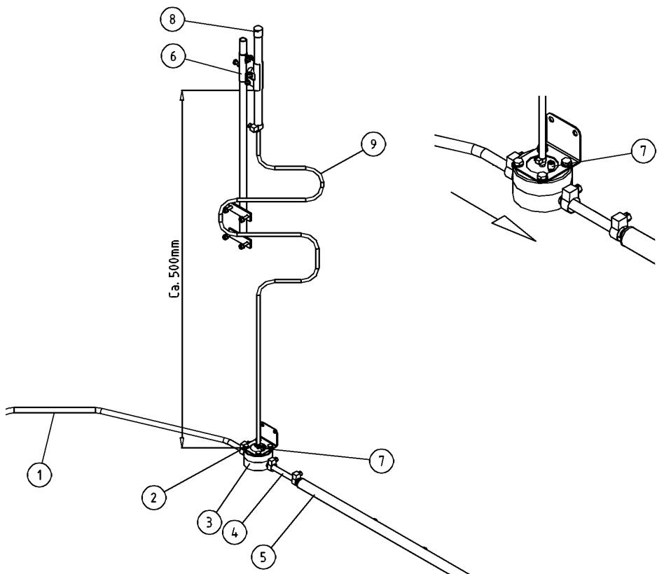
Vid extrema situationer där höjdskillnaden mellan behållarnivå och munstycke är >1,5m och antidroppventil 337535 ej är tillräcklig finns även en el-ventil som tilläggsutrustning. Elho nr. 113350
