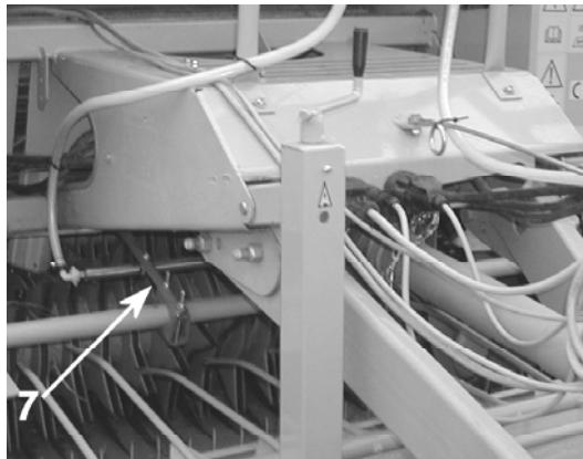
Kiinnitä suutinputken sopivan kohtaan karhon yläpuolelle (mieluummin tuulisuojassa) kiinikkeellä **no.7**.
