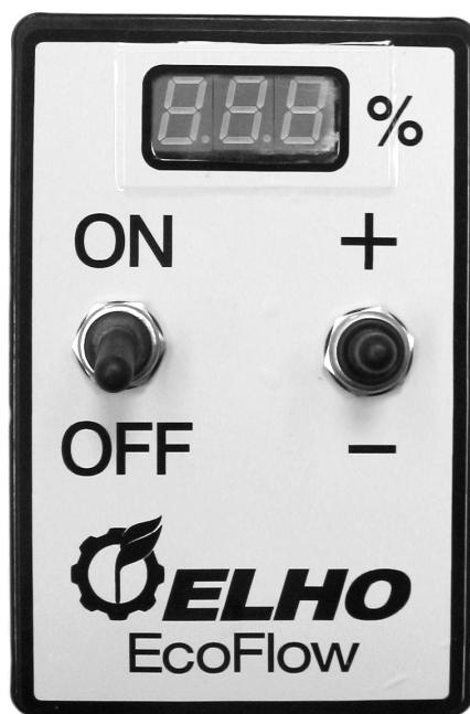
Kääntämällä oikeapuolinen katkaisia + suuntaan nostetaan pumpun kierrosluku ja kääntämällä se - suuntaan lasketaan pumpun kierrosluku. Prosenttiluku talletaan kun katkaisia jää koskematta kahdessa sekunnissa.
