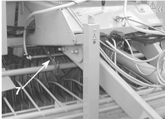
Montera munstycksröret på ett lämpligt ställe på maskinen med tillhörande fästen **nr.7**
