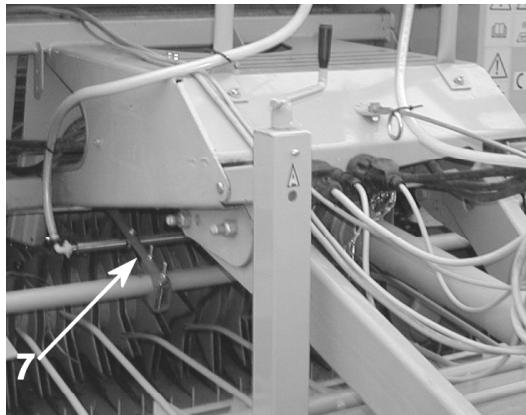
Kiinitä suutinputken sopivan kohtaan karhon yläpuolelle (mieluummin tuulisuojassa) kiinikkeillä **no.7**.
