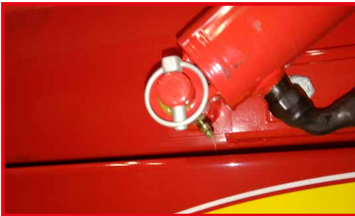
Hydraulisen säiliön korotusosan saranat ja sylinterin päät.
