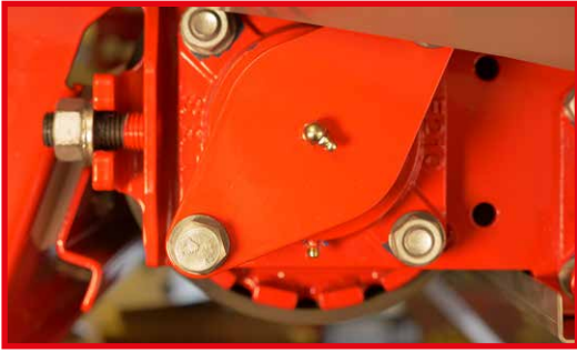
Pohjakuljettimen käytettävien rullien laippalaakerit.
