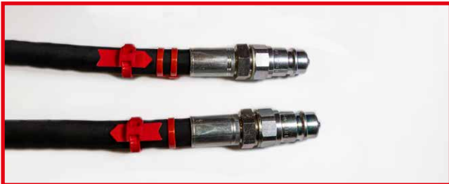
K-XESC Ulkoiset hydrauliset toiminnot ja lohkonhallinta Tasainen virtaus, 70 l/min Paine (1 punainen merkki ja nuoli) Paluu (2 punaista merkkiä ja nuoli)
