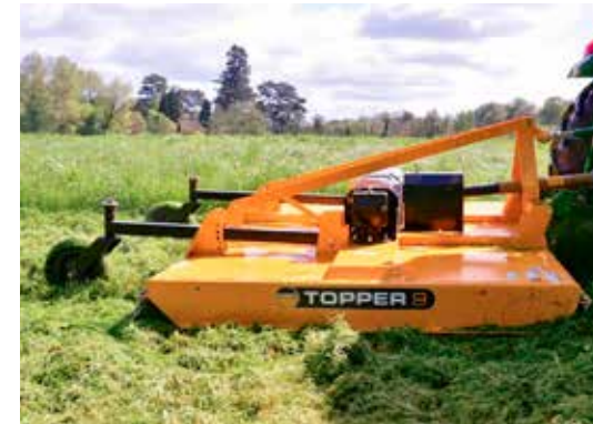
McConnel Topper 9 HD -vaakatasomurskain Vuosimalli 2023. • 2,7 m työleveys • Nostolaitemallinen • Tehontarve vähintään 60 hv • Paino 950 kg
