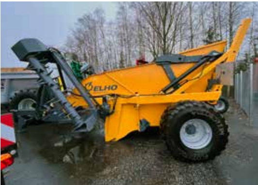
ELHO Scorpion 430 -kivenkeräyskone Vuosimalli 2021. • Tehontarve 60 - 120 kW, paino 5600 kg • Työleveys 4,3 m, kippauskorkeus 2,4 m • Kivikoko 25 - 400 mm
