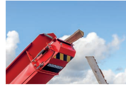
Puhdistava poistokuljetin erottelee roskat, jolloin lopputuotteena saadaan puhtaampaa klapia.
